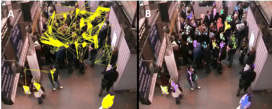
Rysunek 3. Przykład działania algorytmu wykrywania pieszych opartego o grupowanie spójnych wektorów ruchu [26].
