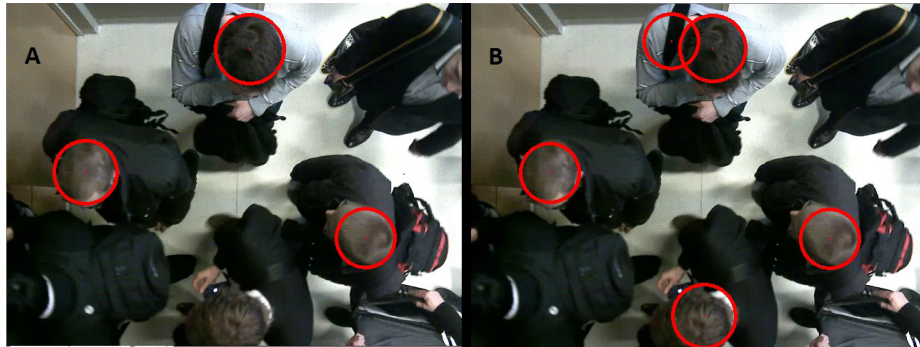
Rysunek 4. Przykład detekcji okręgów (głów pieszych) przy użyciu transformaty Hougha. Zarówno rysunek A jak i B pokazują rezultaty detekcji dokonywane na tej samej ramce obrazu. W przypadku rys. A poziom progów jest zbyt wysoki - niektóre głowy są pominięte. Na rys. B poziom progów jest zbyt niski - wszystkie głowy są wykryte, ale pojawiają się również fałszywe detekcje.
