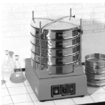
Rysunek 4. Rotacyjna wstrząsarka sitowa „Analysette 18” – do metody suchej (zakres stosowania do pyłów o wielkości ziaren z przedziału 63\mu\text{m} do 6300\mu\text{m} ). Urządzenie firmy Fritsch.
