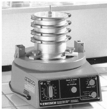
Rysunek 1. Wstrząsarka „Analysette 3” – przesiewacz mikro-precyzyjny dla badania pyłów o wielkości ziarna 5–100 \mu\text{m} . Urządzenie firmy Fritsch.
