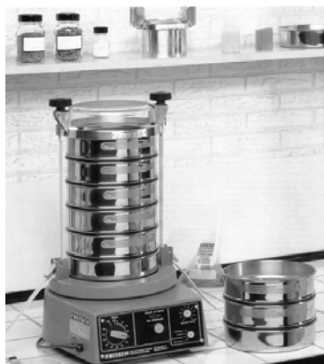
Rysunek 3. Wibracyjna wstrząsarka sitowa „Spartan” – do metody mokrej i suchej (zakres stosowania do pyłów o wielkości ziaren z przedziału 20\mu\text{m} do 2500\mu\text{m} ). Urządzenie firmy Fritsch.
