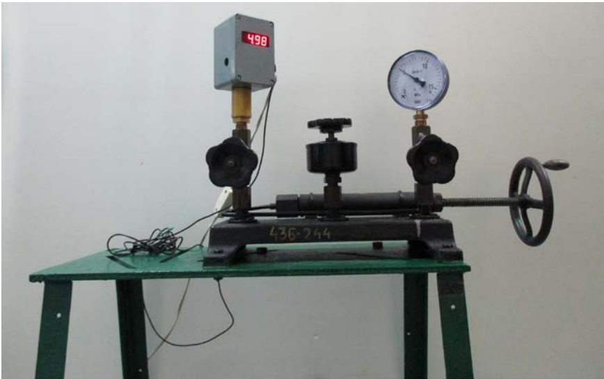
Rys. 1 Stanowisko do sprawdzania dokładności i histerezy manometrów
