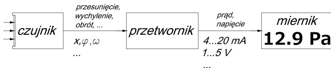
Rys. 12 Schemat zasady działania manometru elektrycznego
