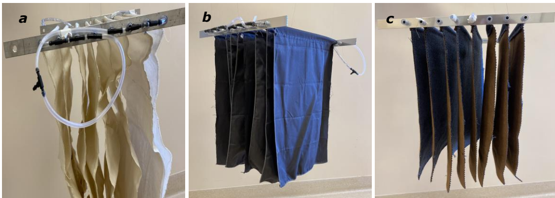
Rys. 5. Żaluzje nawilżające wykonane z trzech różnych materiałów: a – lniane, b – z materiału szybko schnącego, c – z materiału hydrofobowego
