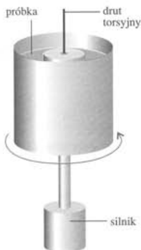
23.6 Rotacyjny wiskozymetr bębnowy. Bada się moment siły działający na wewnętrzny cylinder, podczas gdy obracany jest cylinder zewnętrzny
