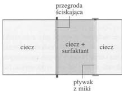
23.27 Schemat aparatu stosowanego do mierzenia ciśnienia powierzchniowego i innych charakterystyk filmów powierzchniowych. Surfaktant nanosi się na powierzchnię cieczy w korytku, a następnie ściska się go poziomo, przesuując przegrodę ściskającą w kierunku pływaka z miki. Pływak ten jest połączony z drutem wagi skrętnej i w ten sposób można mierzyć różnicę sił po obu stronach pływaka
