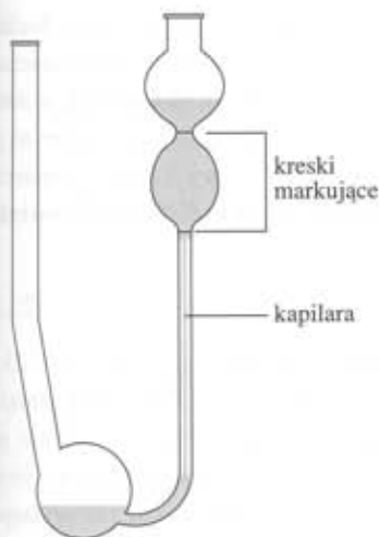
23.5 Wiskozymetr Ostwalda. Lepkość wyznacza się, mierząc czas wypływu roztworu z przestrzeni wyznaczonej przez dwie kreski markujące
