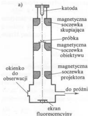
Rys. 7.7. Mikroskop elektronowy: a) schemat budowy; b) fotografia aparatury JEM-100 U (prod. japońskiej)
