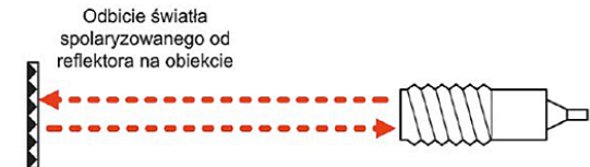
Rysunek 7. Sensor fotoelektryczny wykorzystujący odbicie światła spolaryzowanego od obiektu
