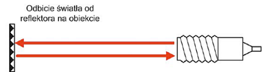
Rysunek 6. Sensor fotoelektryczny wykorzystujący bezpośrednie odbicie od zwierciadła na obiekcie
