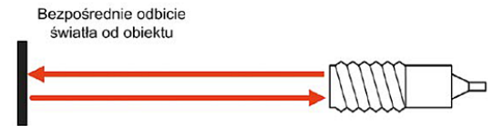
Rysunek 5. Sensor fotoelektryczny wykorzystujący bezpośrednie odbicie od obiektu
