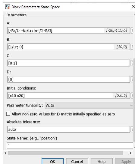
Fig. 2.10. Motor model parameters
