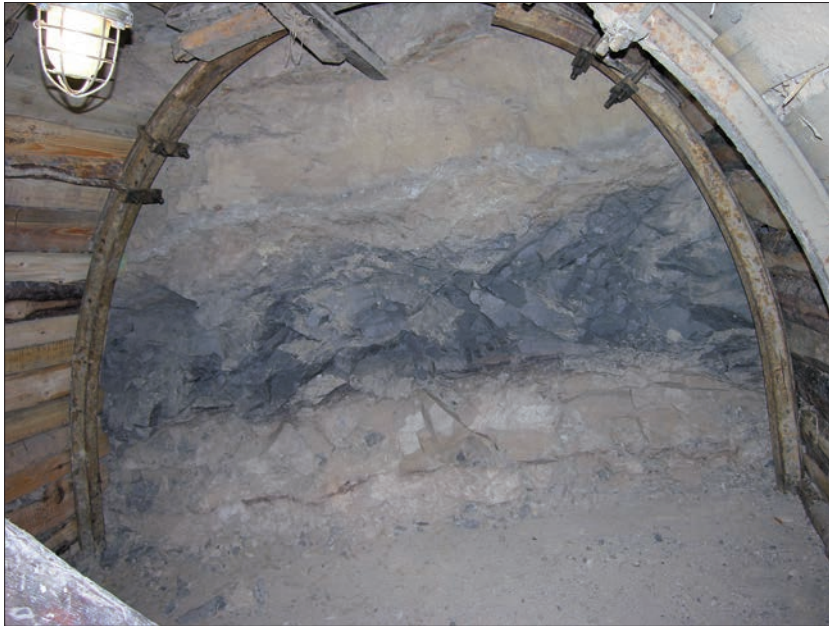
Fot. 7.20. Firma „Opoczno S.A.”. Kopalnia podziemna ilów jasno wypalających się Żarnów (woj. łódzkie), przodek eksploatacyjny. Stan z 2006 r.
