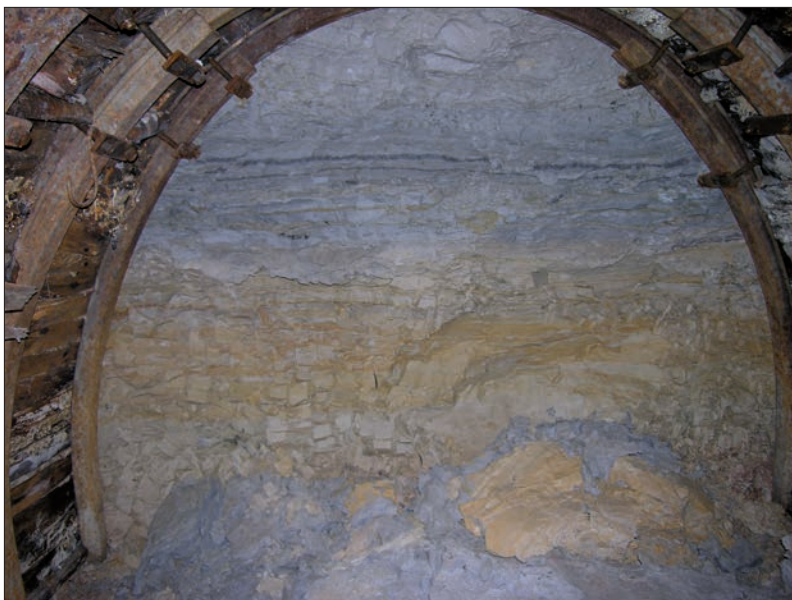
Fot. 7.17. Firma „F. Jopek Ceramika”. Kopalnia podziemna ilów jasno wypalających się w Zapniowie (woj. świętokrzyskie), przodek eksploatacyjny. Stan z 2006 r.
