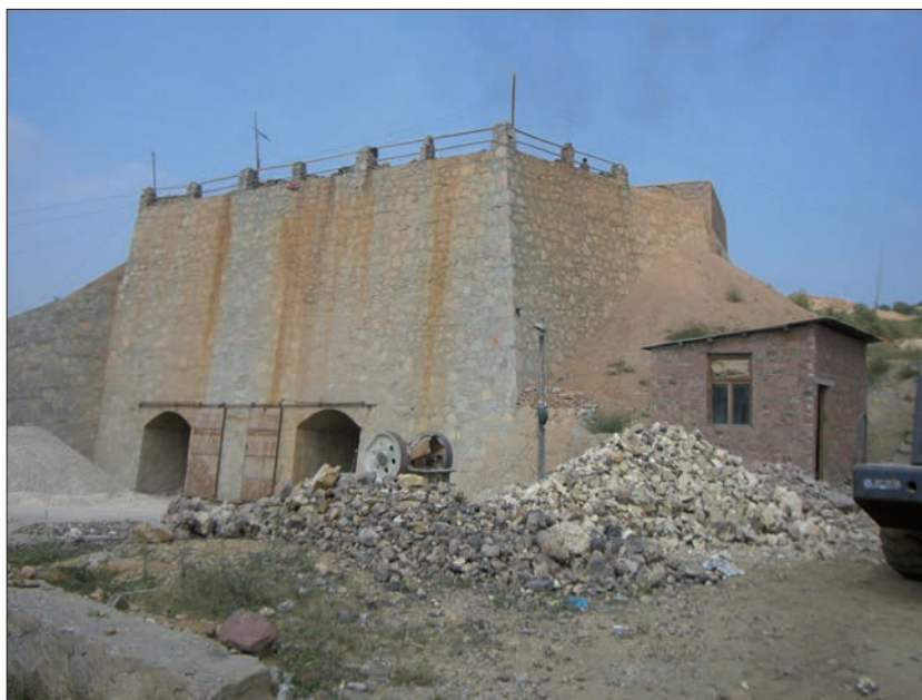
Fot. 8.5. Piec szybowy do kalcynacji boksytu w prowincji Shanxi (Chiny)
