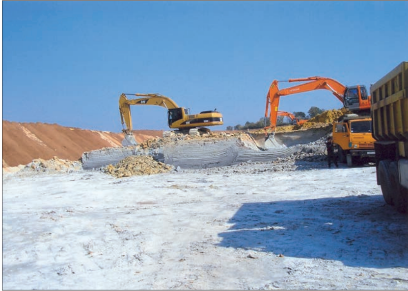
Fot. 7.9. Firma „Donbas Clays” (Mercałowo, Ukraina), Kopalnia ilów biało wypalających się Kuczerowjarskoje (region doniecki). Widoczna selektywna eksploatacja pokładu ilów. Stan z 2005 r.
