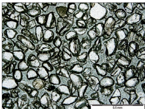
Fot. 12.1. Piasek cyrkonowy australijski. Widoczne niemal wyłącznie obtoczone ziarna cyrkonu o silnym reliefie i żywych barwach interferencyjnych. Mikrofotografia – mikroskop polaryzacyjny. Jeden polaroid (z lewej) i polaroidy x (z prawej)
