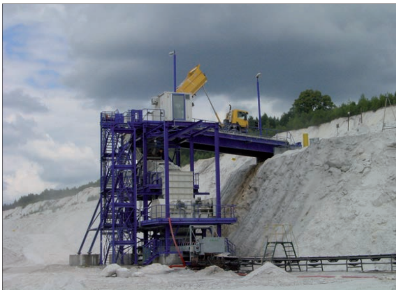
Fot. 5.2. Kopalnia i Zakład Przeróbcy Piasków Szklarskich „Osiecznica” . Węzeł wstępnego kruszenia piaskowca kwarcowego bezpośrednio w wyrobisku kopalni Osiecznica (Dolny Śląsk). Stan z 2005 r.
