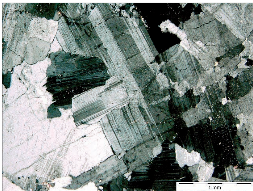
Fot. 6.4. Leukogranit Strzeblów. Widoczne niemal wyłącznie kwaśne plagioklasy. Mikrofotografia – mikroskop polaryzacyjny. Polaroidy x
