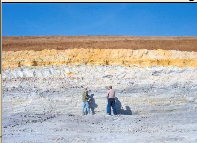
Kopalnia Nowoandriejewskoje Dwumetrowy pokład ility pod nadkładem grubości ponad 30 m.
