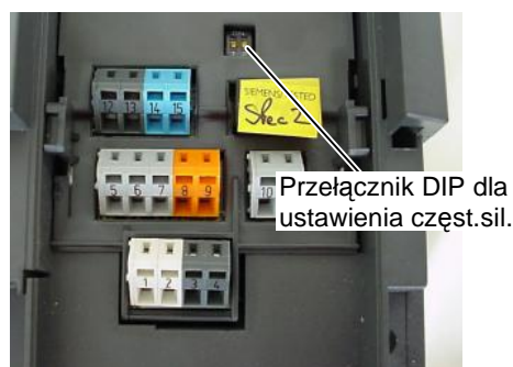
Rys. 3-3 Przełączniki DIP do wyboru częstotliwości silnika
