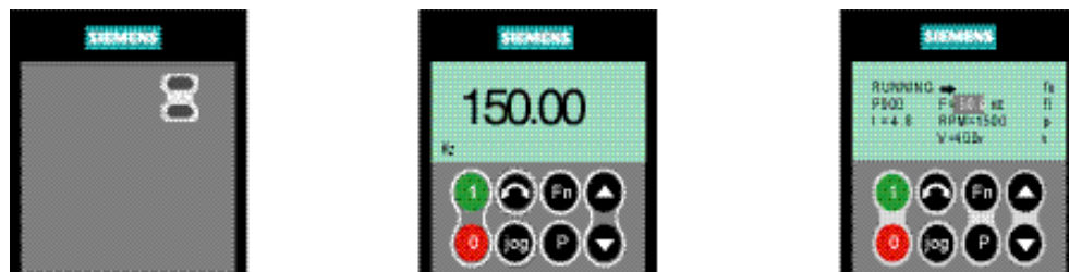
SDP (Status Display Panel) Panel wyświetlacz statusu BOP (Basic Operator Panel) Podstawowy panel operatorski AOP (Advanced Operator Panel) Zaawansowany panel operatorski
