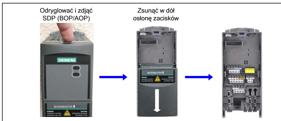
Rys. 1-1 Zdejmowanie osłon
