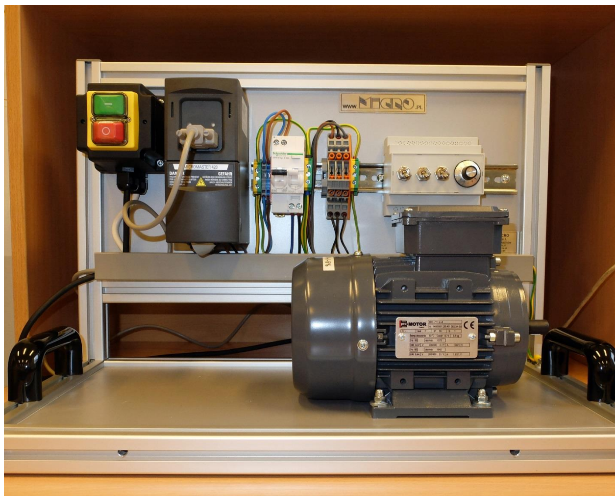
Rys. 6.1. Silnik elektryczny z falownikiem i osprzętem.
