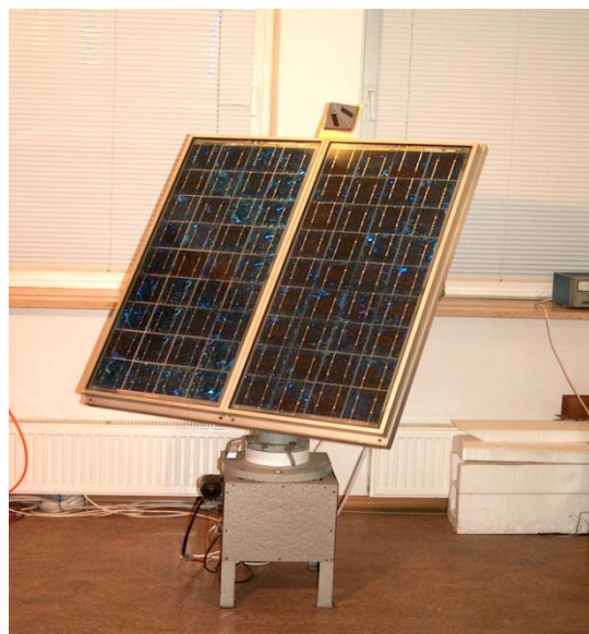
Fot. 9.1 Model nadążnego układu ogniw fotowoltaicznych
