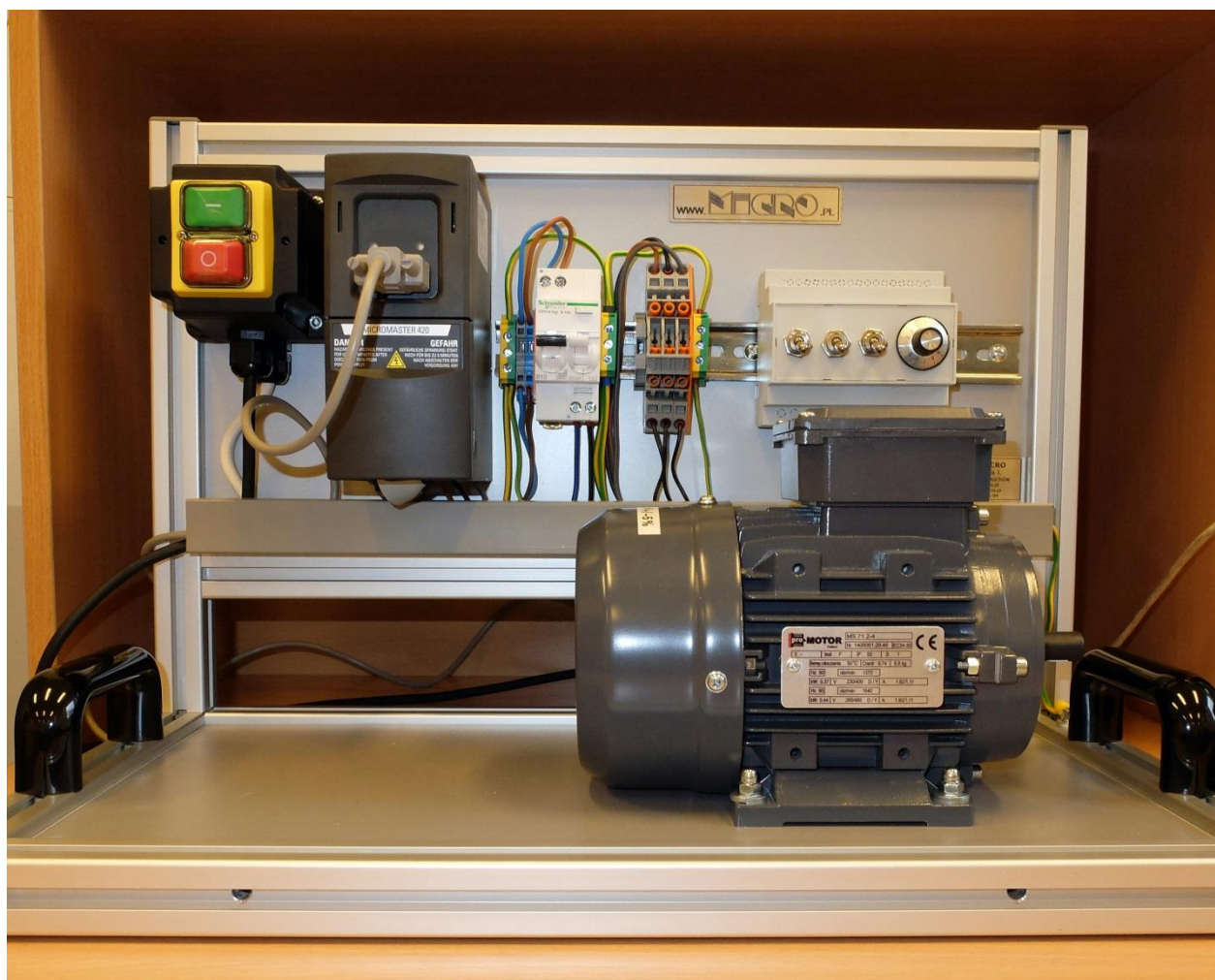
Rys. 6.1. Silnik elektryczny z falownikiem i osprzętem.
