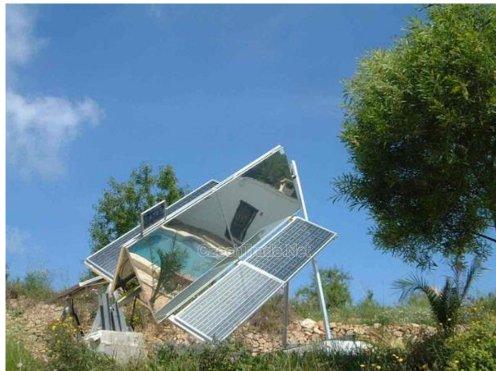
Układ koncentratorowy ok. 1,5:1 Moc całkowita ok. 1,5 kW
