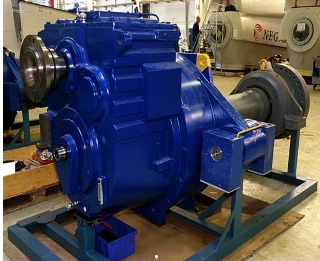
Rys. 28. Skrzynia biegów elektrowni wiatrowej.
