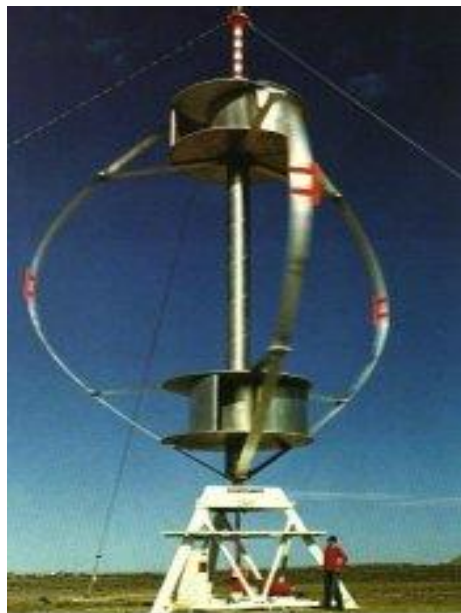
. Przykład konstrukcji łączonej, główny wirnik typu Darrieusa, natomiast pomocniczy Savoniusa.
