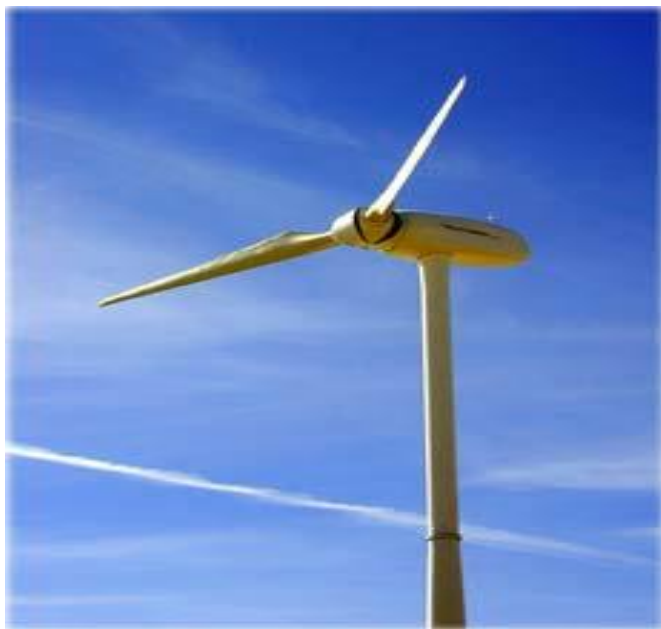
Rys. 41. Siłownia typu down-wind o mocy 750 kW firmy Wind Turbine Company.
