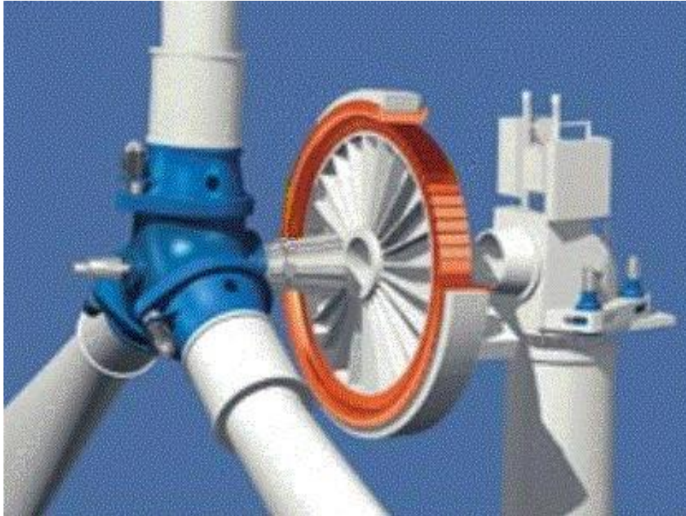
Rys. 29. Siłownia wiatrowa bez przekładni głównej i charakterystyczna sylwetka gondoli.
