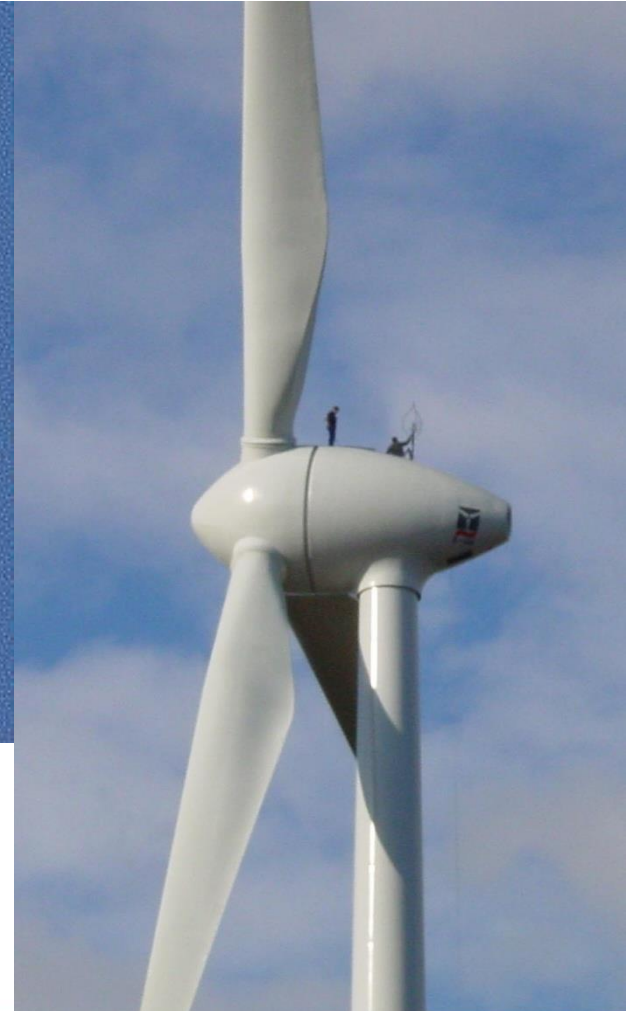
Rys. 29. Siłownia wiatrowa bez przekładni głównej i charakterystyczna sylwetka gondoli.
