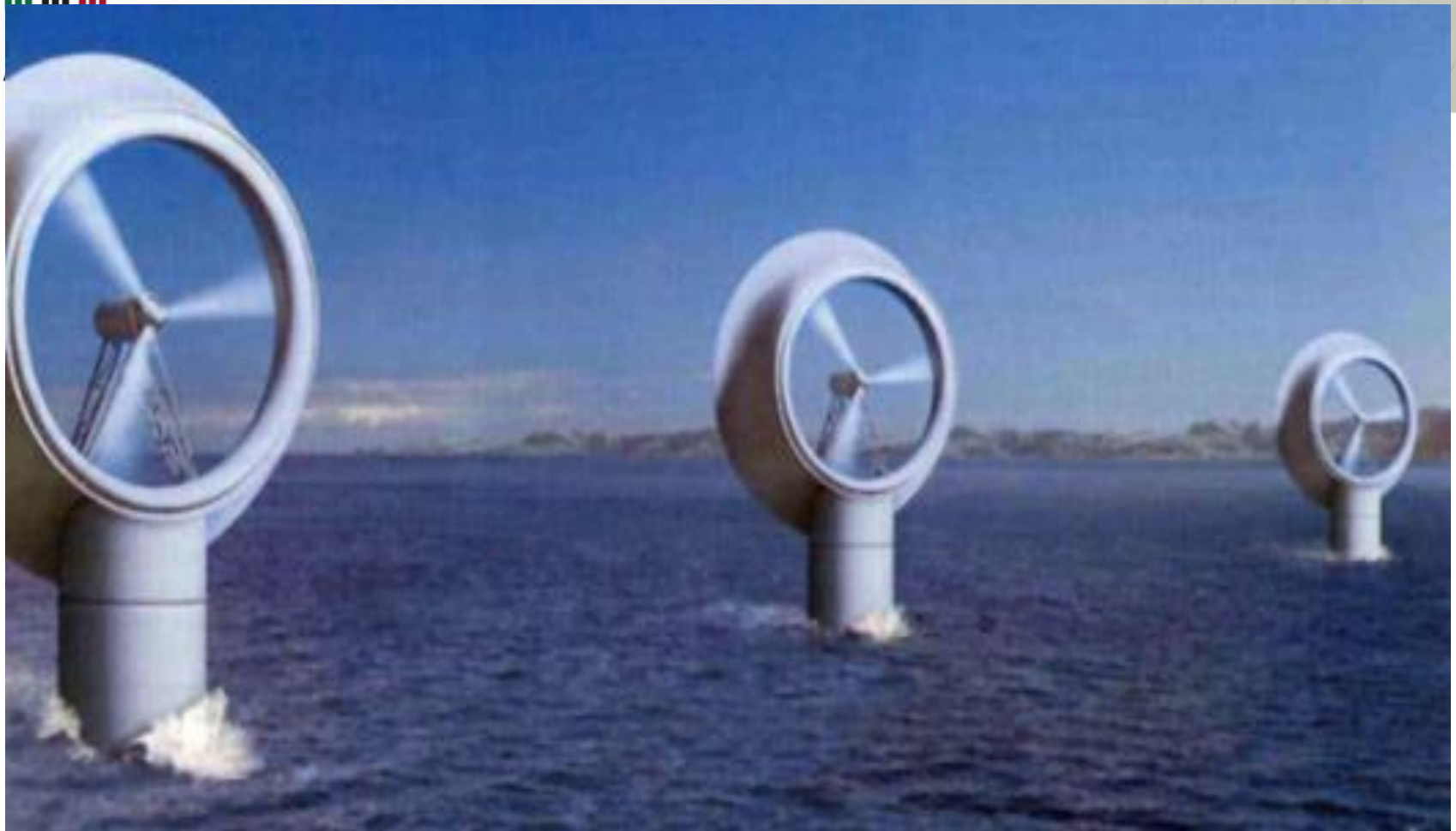
Rys. 44. Turbiny firmy Vortec o średnicy wirnika 66 m i mocy 5 MW.
