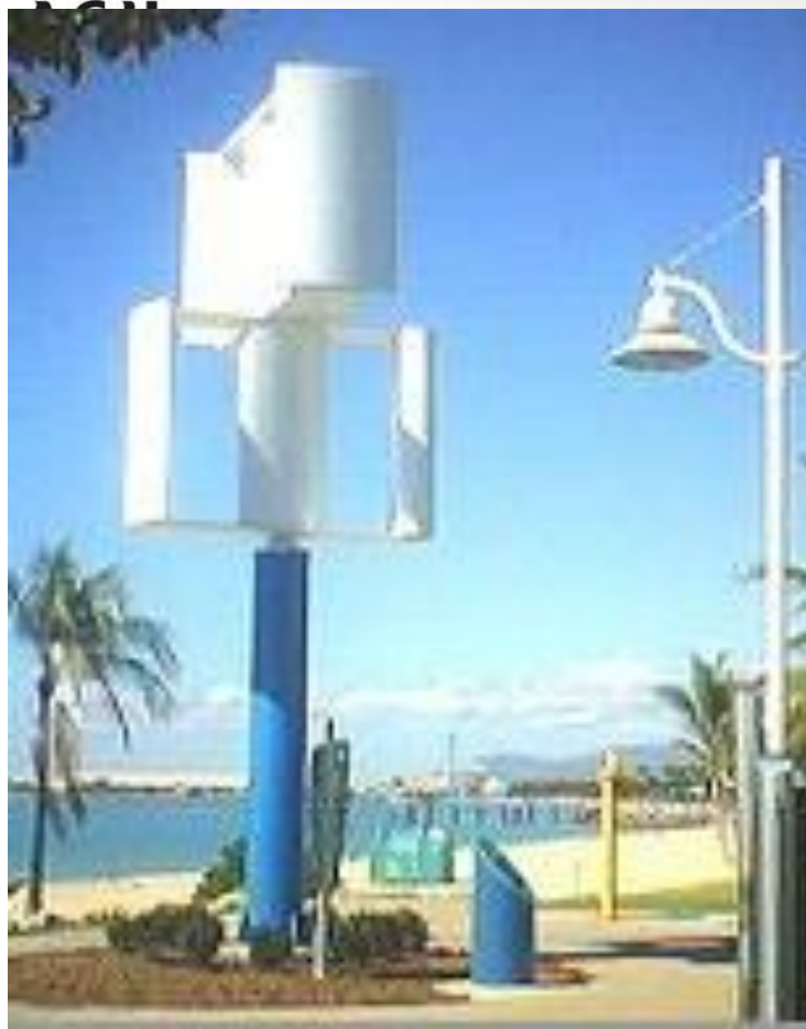
Rys. 58. Siłowni w Townsville o mocy 6 kW.
