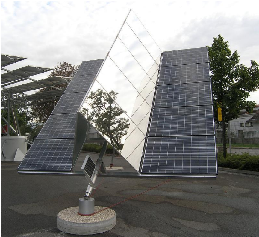
Układ koncentratorowy ok. 1,5:1 Moc całkowita ok. 3,5 kW
