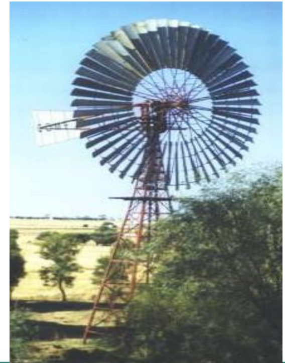
Rys.40. Zdjęcia przedstawiają: po lewej wiatrak używany w Wimberley w Teksasie, a po prawej w Springsure w Australii. Oba wykorzystywane były do pompowania wody.
