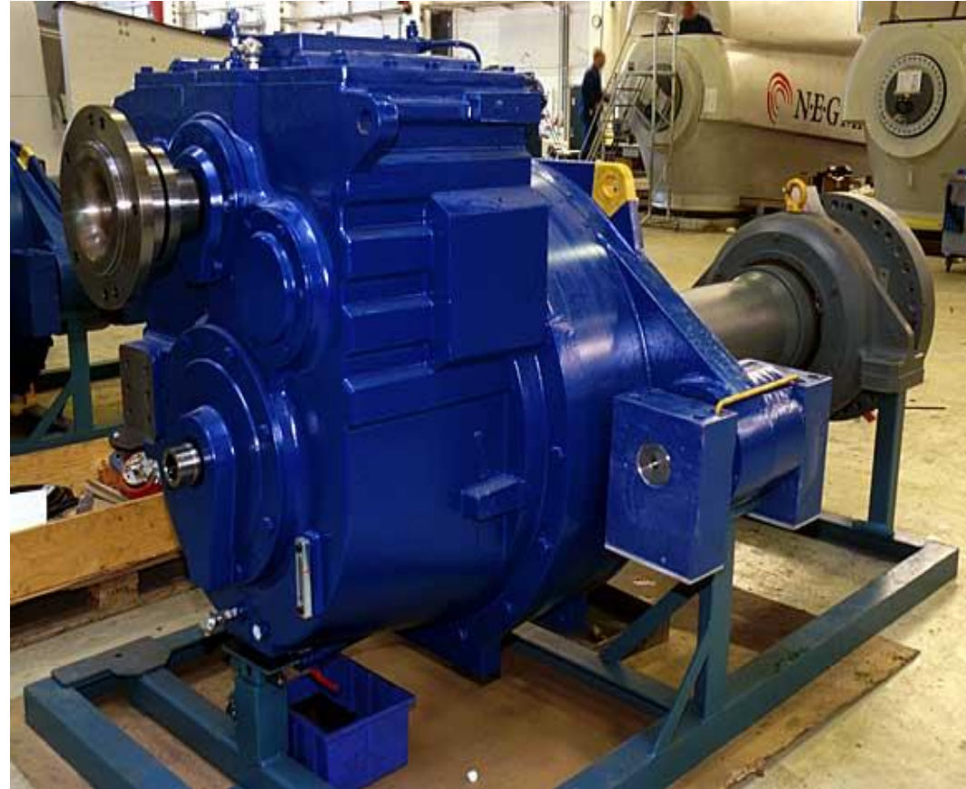
Rys. 28. Skrzynia biegów elektrowni wiatrowej.
