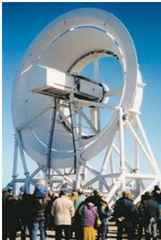
Rys. 45. Siłownia firmy Vortec z szczeliną w dyfuzorze.
