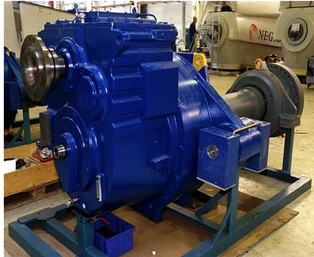
Rys. 28. Skrzynia biegów elektrowni wiatrowej.
