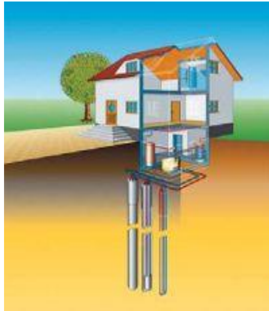
Pionowy wymiennik gruntowy (40-150m)
