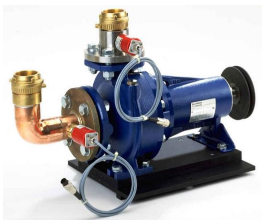
Rys.9. Pompy zainstalowane w lab. KMCiP a) widok ogólny, b) przekrój wzdłużny (1-obudowa spiralna, 2-pokrywa obudowy, 3-wspornik, 4-wał, 5-wirnik, 6-łożysko kulowe, 7- gniazdo łożyska, 8,9-uszczelnienia wału)
