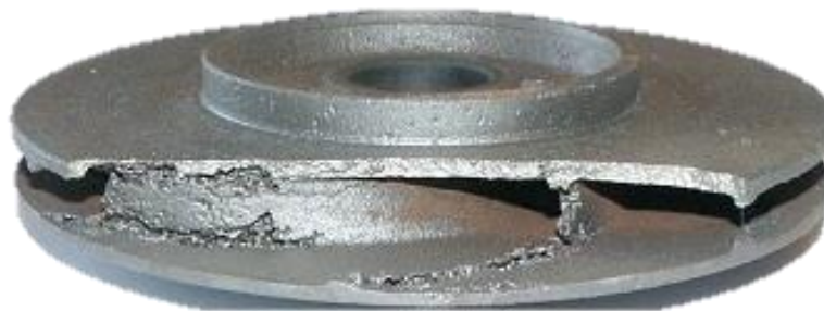
Rys.5. Wirnik pompy z widocznymi wżerami kawitacyjnymi
