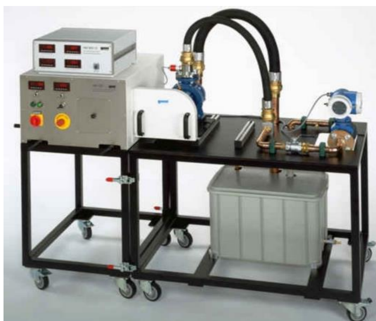
Rys.10. Widok ogólny stanowiska do badania pomp w KMCiP
