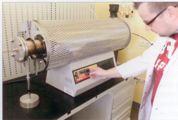
Stanowisko do oceny wysokotemperaturowej korozji materiałów w środowiskach agresywnych nagrodzone Złotym Medalem 2016 MTP
