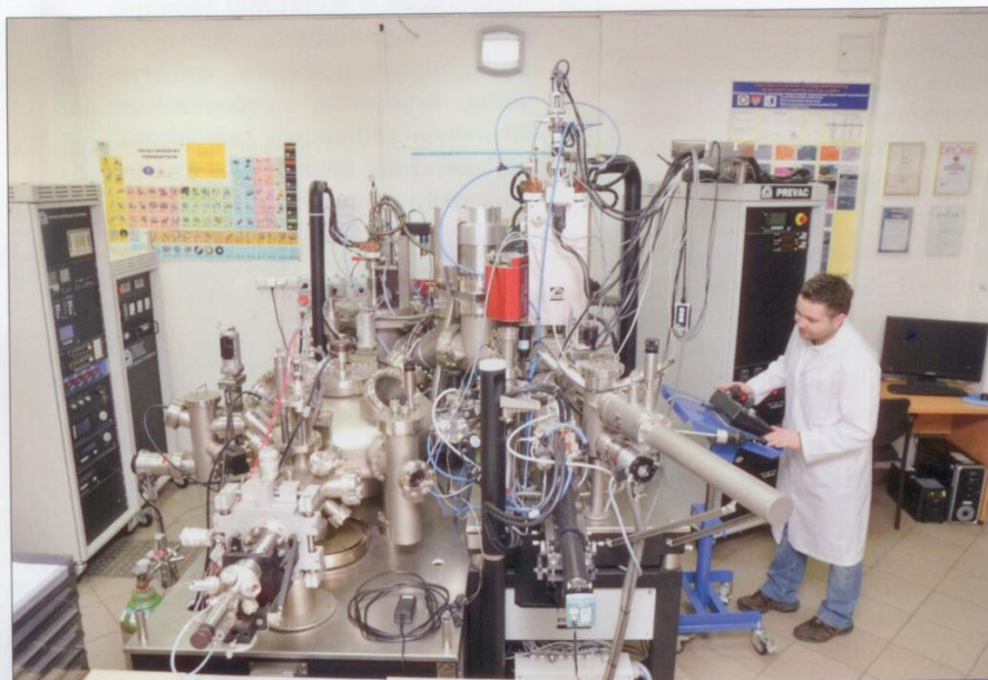
Wysokotemperaturowe stanowisko do badań oddziaływania ciekłych metali i stopów z materiałami ogniotrwałymi w warunkach izotermicznych i nieizotermicznych nagrodzone Złotym Medalem WYBÓR KONSUMENTÓW MTP
