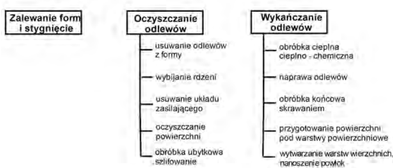
Rys. VII.1.1. Procesy obróbki końcowej odlewów; opracowanie własne, na podstawie literatury [1÷8]
