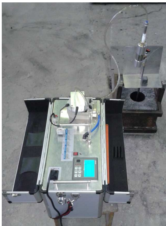
Rysunek 9. Realny schemat stanowiska do oznaczania objętości wydzielanych gazów (gazotwórczości) i emisji BTEX z mas (fot. Sylwia Żymankowska-Kumon)
