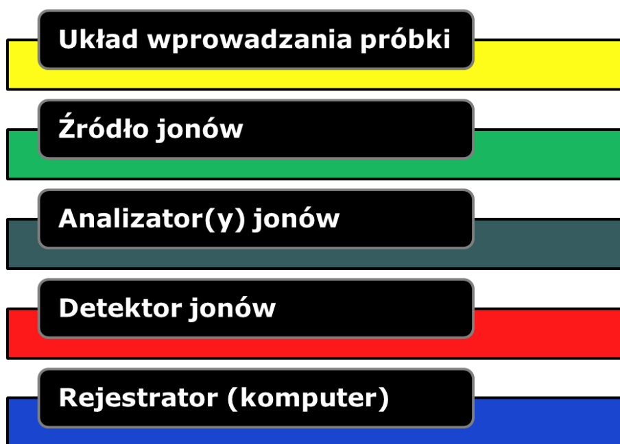
Rysunek 1. Segmenty spektrometru masowego
