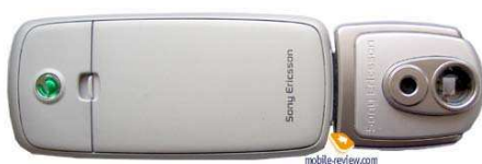
Rys.1a Zewnętrzna kamera MCA-25 SonyEricsson. Rysunek ze strony: http://www.mobile-review.com/articles/2003/camera-phone-en.shtml
