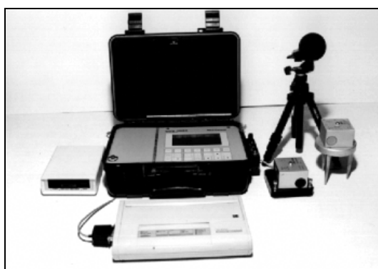
Rys. 3. Rodzina rejestratorów typu UVS, UVS1608 (a) i UVS 1504 (b)
