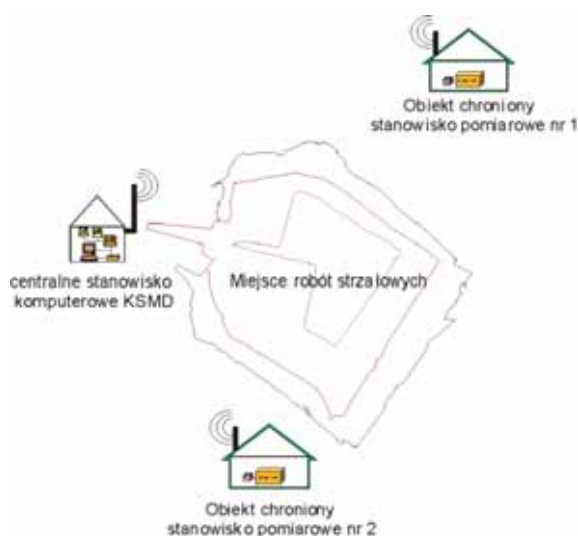
Rys. 8. Schemat systemu Kopalnianej Stacji Monitoringu Drgań [7]
