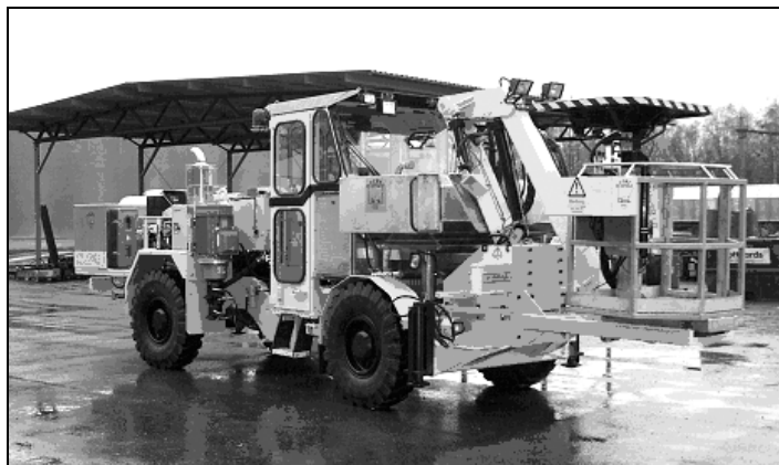
Rys. 4. Urządzenie Mini-SSE zamontowane na podwoziu wozu typu DC17B z wysięgnikiem W46 [3]
