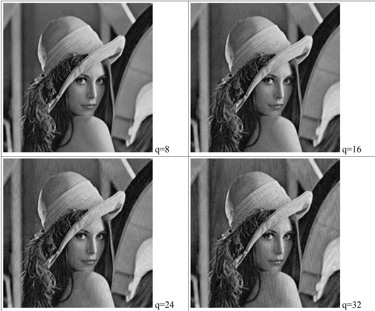
Obraz Lene skompresowany i zrekonstruowany z różnymi wartościami kwantyzatora q .
