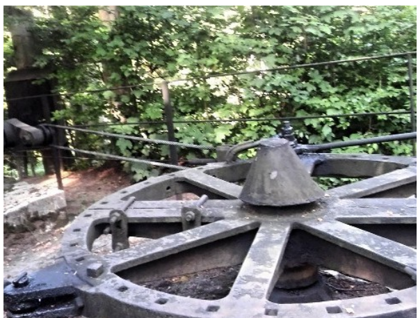
Rys. 49. Koło napędzające kilka kiwaków
