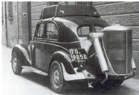
Rys. 202. Samochód z generatorem "holzgasu"
