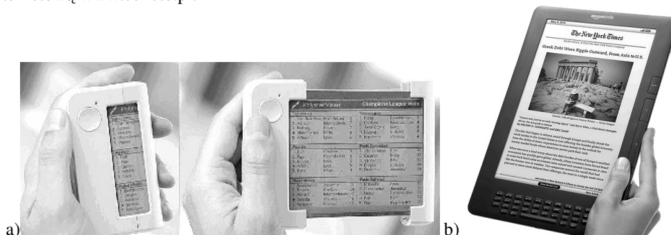
Rys. 3.29. Przykłady wyświetlaczy typu "elektroniczny papier":
