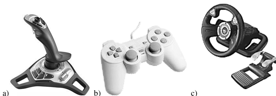
Rys. 3.17. Manipulatory dla gier i symulatorów komputerowych: a) dżojstik, b) panel sterowniczy, c) kierownica i pedały symulatora samochodu
