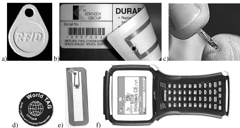
Rys. 7.3. RFID - Identyfikacja radiowa: a), b), c), d), e) – identyfikatory, f) czytnik
