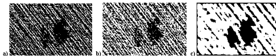
Rys. 5.86. Binarystacja różnicowa obrazów: (a) i (b) różne progi binaryzacji, (c) po dodatkowej filtracji medianowej (okno medianizacji: 15x15)
