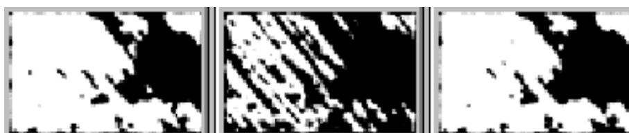
Rys. 5.87. Wyniki odejmowania i binaryzacji ze stałym progiem. Obraz środkowy błędny.
