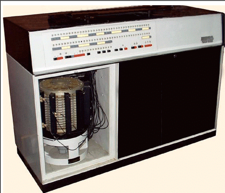
ODRA 1013 z widoczną pamięcią bębnową
