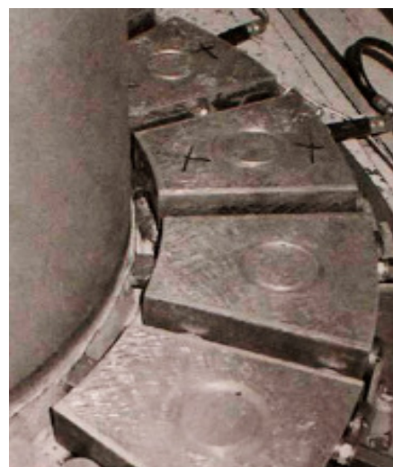
Wielosegmentowe łożysko wzdłużne turbiny hydrogeneratora o średnicy 1300 mm
