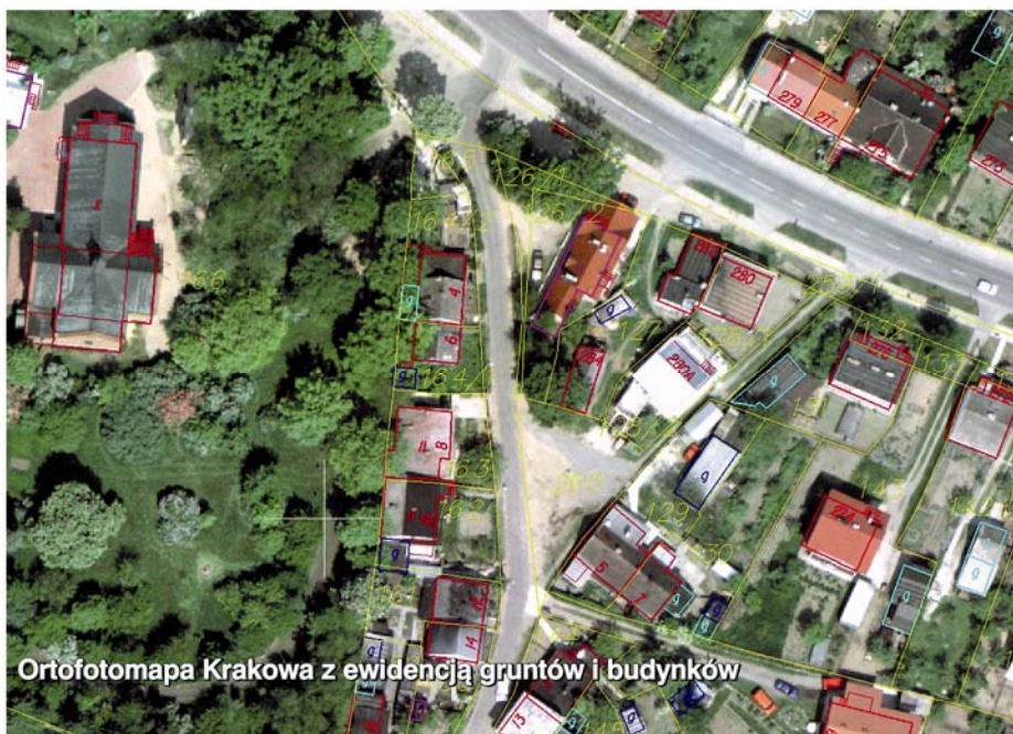
Rys.3.: Fragment opracowania testowego ortofotomapy ewidencyjnej dla obrębu Wola Justowska w Krakowie wykonanego dla Krakowskiego Geodety Wojewódzkiego (stosowano skale 1:500, 1:1000, 1:2000).
