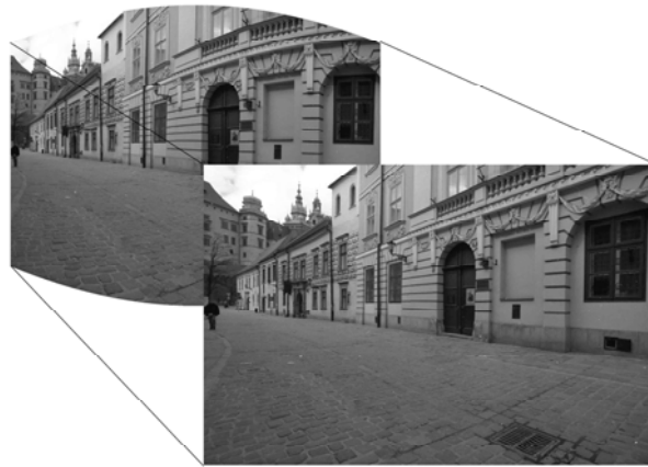
Rys.3 Zniekształcenie obrazu powstałe na skutek przekształcenia powierzchni zdjęcia na powierzchnię cylindryczną walca.
