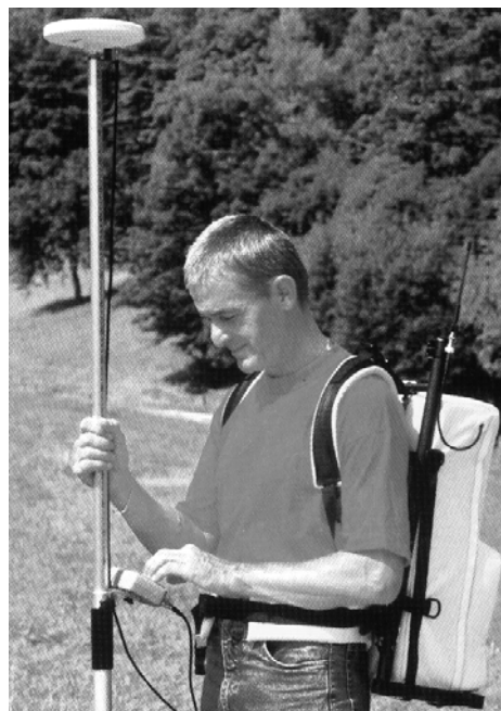
Pomiar „geodezyjnym” odbiornikiem GPS w czasie rzeczywistym
