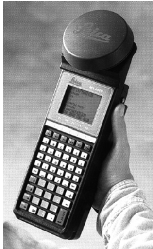
Odbiornik DGPS jednoczęstotliwościowy Możliwy pomiar kodowy i fazowy
