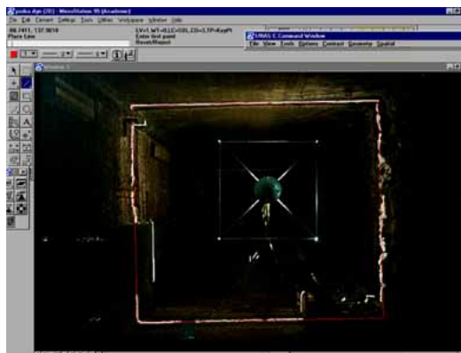
Rys.8. Na mierzonym zdjęciu czerwoną linią oznaczono teoretyczny przekrój chodnika.
